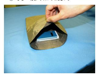
④ 生地を3回程度折り返して、クリップで留めます。 その後で、携帯電話を呼び出します。多分、不感状態です。携帯電話各社、又は、携帯エリアにもよりますが、シールド性能は、約-50dB 程度確保されています。
